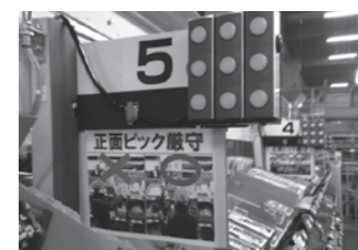
集品ミスの削減に向けて、DPS作業の正面投入の徹底を行いました。
